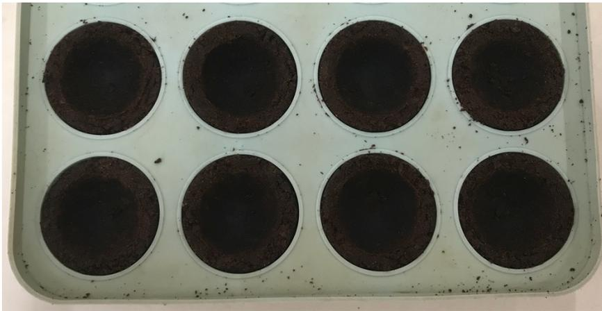
Figura 18- Embalagem alimentar à escala piloto antes de ser submetida ao aquecimento (diâmetro 3,7 cm e altura 1,7 cm)..
