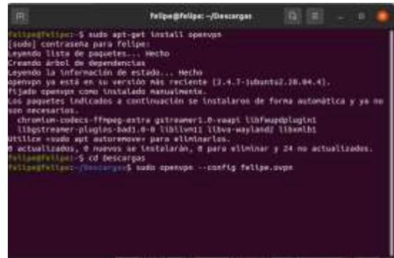
Figura 45. Terminal de Ubuntu en la cual se descarga el OpenVPN
