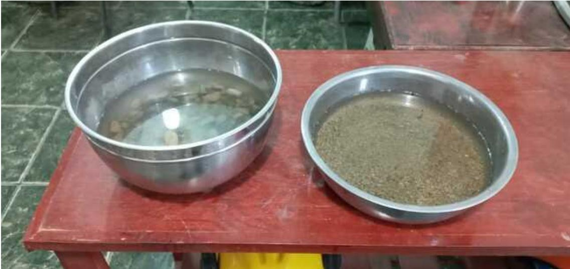
Saturación de agregados
