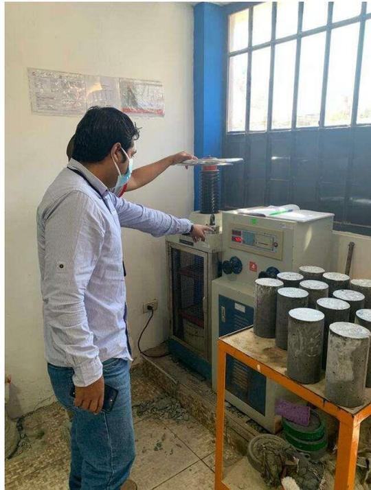
**Colocación de testigo en la prensa.**
