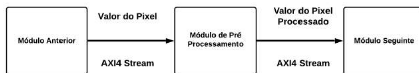
Figura 3.7: Representação gráfica da estrutura dos módulos de pré-processamento de imagem
