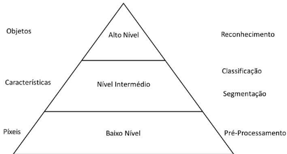
Figura 2.1: Esquema de operações de processamento de imagem (Adaptado de: [7])
