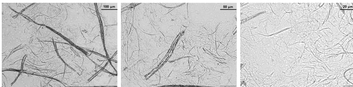
Figura 4.1 Imagens de microscopia ótica de microfibrilas de celulose obtidas após o pré-tratamento enzimático, a diferentes ampliações (imagens cedidas por Universidade de Coimbra).
