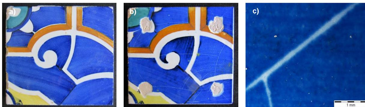
**Figura 6.9** Azulejo FAZ049-1: a) sem recozimento; b) evidência das fissuras após o recozimento; c) imagem de microscopia ótica da fissura com preenchimento do vidrado branco subjacente.
