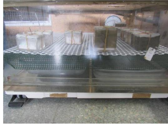
**Figura 5.5** Ensaio de permeabilidade ao vapor de água efetuado às pastas estudadas e chacotas modernas.
