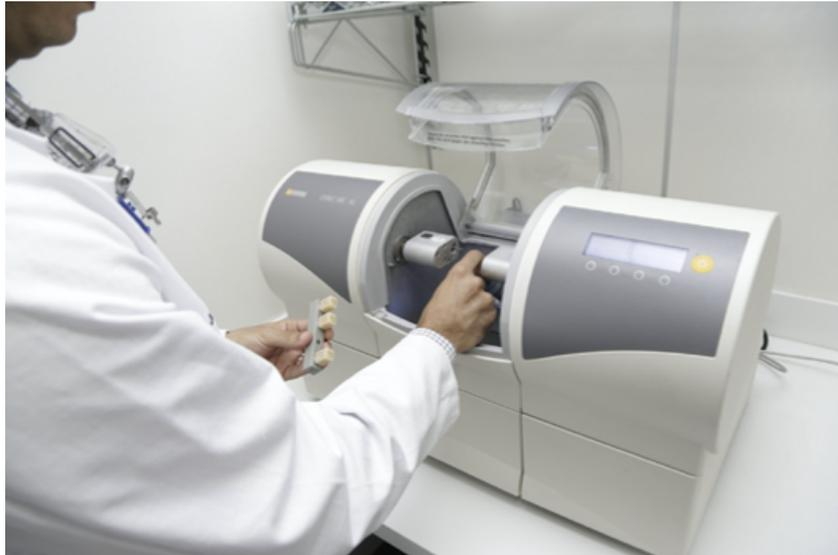
Figura 2 -CAM - As fresadoras Chairside têm um tamanho reduzido e são adequadas para uma variedade de tipos e materiais de restaurações (Blatz, 2019)
