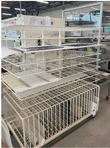
Figura 26 – Estendal utilizado para secagem das peças após aplicação de cola.
