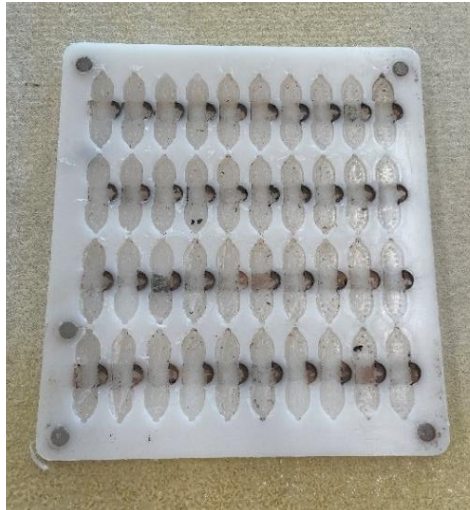
Figura 24 – Gabarito utilizado para a aplicação de cola em passants .
