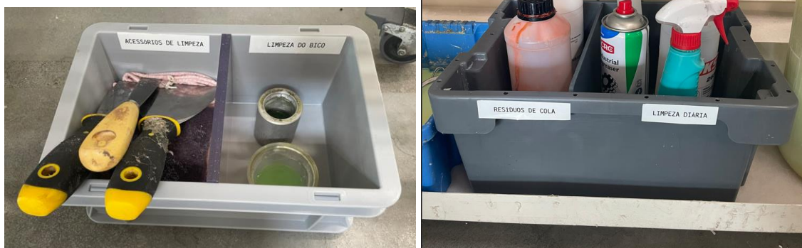
Figura 56 – Aplicação da ferramenta 5S à zona inferior do robot de cola.
