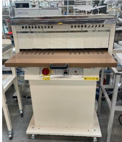
Figura 27 – Forno flash para ativação da cola C19016.
