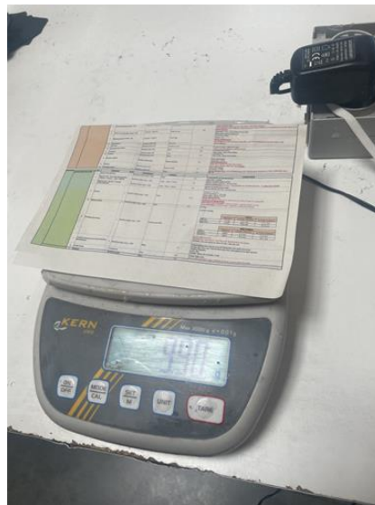
Figura 22 – Pesagem da folha A4 para o processo de gramagem de cola.
