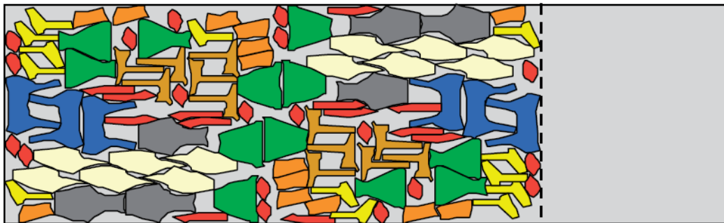
Figura 14 – Exemplo de um layout otimizado pelo processo Nesting [67].
