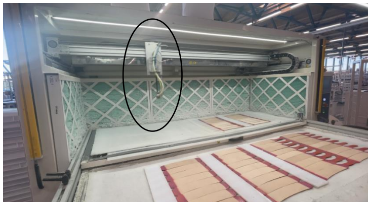
Figura 41 – Não limitação da manobra do robot de cola C19016.
