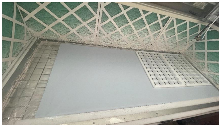
Figura 50 – Teste das placas no processo de colagem automático com recurso a gabaritos.
