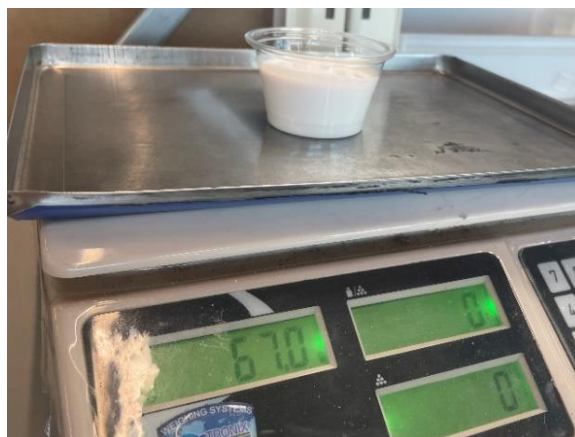
Figura 37 – Medição de cola dos copos do processo de colagem manual.
