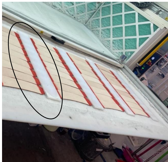
Figura 44 – Utilização de gabaritos na aplicação de cola nos poignées .
