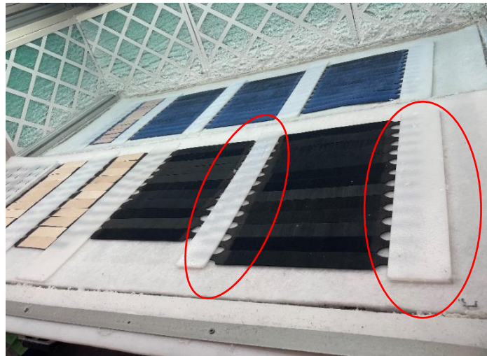
Figura 23 – Utilização de gabaritos no processo de colagem dos poignées .
