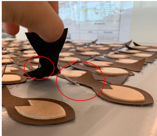
Figura 53 – Sujidade das peças após testes e aderência das mesmas à placa.
