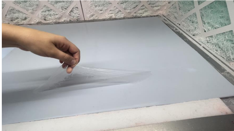
Figura 51 – Remoção da película de cola das placas após o período de secagem.
