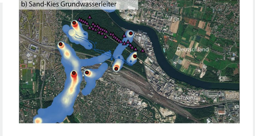
Fig. 2 Räumliche Zuströmlinien-Dichteverteilungen für (a) die Trinkwasserbrunnen und (b) den Sand-und-Kies-Grundwasserleiter. Die Partikelrückverfolgung wurde für 880 kalibrierte Modellrealisierungen durchgeführt (verändert nach [16]).
