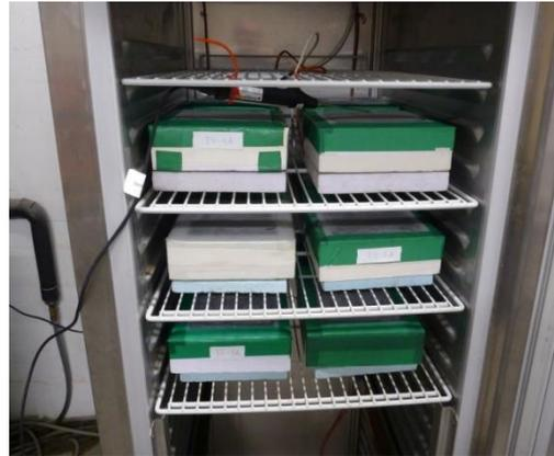
**Bild 3** Prüfgerät („Slab-Tester“) mit Probekörpern im Innenraum
