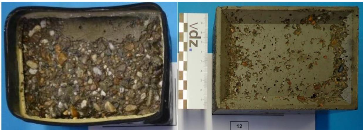
**Bild 9** Ebene Prüffläche nach Belastung mit 1 mm dicker Eischichtdicke
