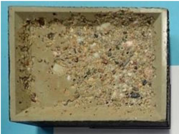
**Bild 11** Probekörper mit seitlicher Abdichtung (Präparationsart #07a)
