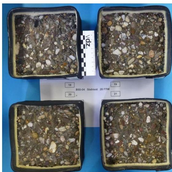
**Bild 8** Prüffläche des Betons mit CEM I 42,5 R und nach 28 FTW im Plattenprüfverfahren (Slab-Test)
