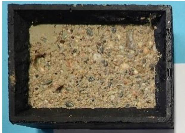
**Bild 12** Probekörper mit Abdichtung der Seitenflächen und Aufkantung, während der Frostlagerung mit Moosgummi-band und Frischhaltefolie versehen (Präparationsart #07)
