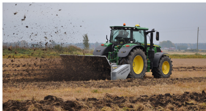
Kuva 7. BioRotor-juolannostimessa roottorin rakenne on tehty niin vahvaksi, ettei esimuokkausta tekevää kultivaattoriosaa tarvita.
