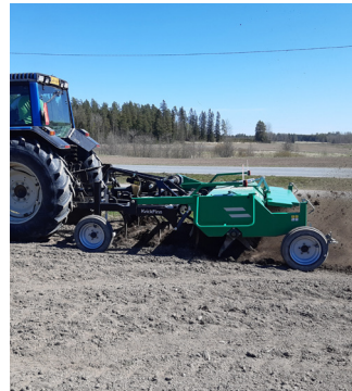
Kuva 4 ja 5. Kvick-Finn -juolannostimen versio savimaille. Normaalit piikit (vrt. kuva 3) on korvattu kuvassa näkyvällä järeällä roottoriyksiköllä.
