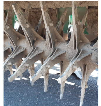
Kuva 4 ja 5. Kvick-Finn -juolannostimen versio savimaille. Normaalit piikit (vrt. kuva 3) on korvattu kuvassa näkyvällä järeällä roottoriyksiköllä.
