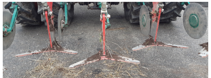
Kuva 6. Kverneland-juuristoleikkurissa on läpileikkaavat terät, joilla voi katkaista kestorikkakasvien juuristoa maata kääntämättä. Muokaussyvyyttä säädetään rikkakasvilajin ja ajankohdan mukaan.
