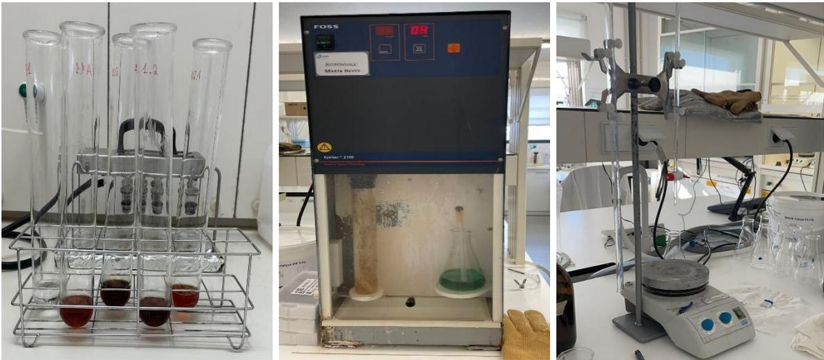
**Figura 7:** Equipamentos e material utilizados para determinação da proteína: a) tubos Kjeldahl, b) destilador Foss Kjeltec 2100 e c) material para titulação.
