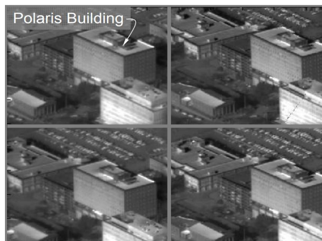
Рисунок 2.6. Зображення, отримані використовуючи, камеру на основі архітектури поділу апертурної діафрагми
