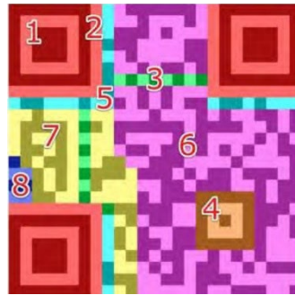
Рис. 1.2. Структура QR-коду версії 2.
