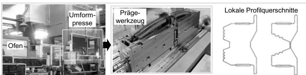
Abbildung 2-8: Accra-Technologie - Anlage zum Warmumformen der veränderlichen Querschnitte (links), Prägewerkzeug mit Bauteil (mittig), lokale Querschnitte des finalen geschlossenen Profils (rechts) [GIE06]
