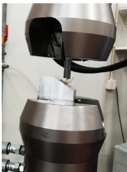
Figura 10 – Ensaio preliminar com um implante de teste
