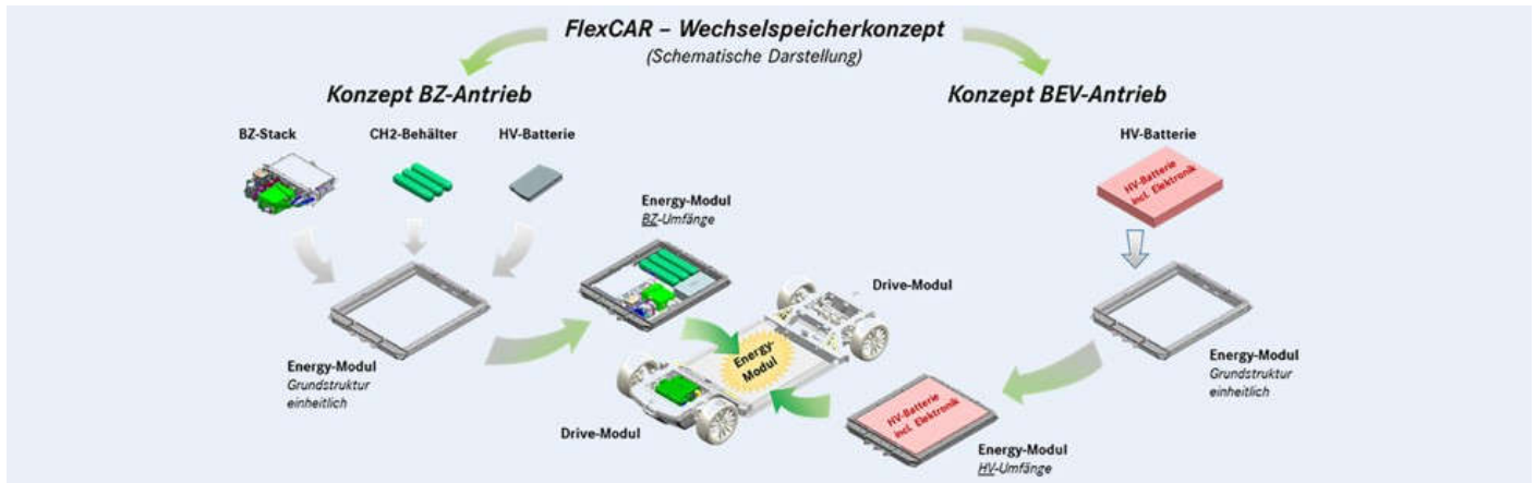
Bild 3. Prinzip des Wechselspeicherkonzeptes. Grafik: Mercedes-Benz AG
