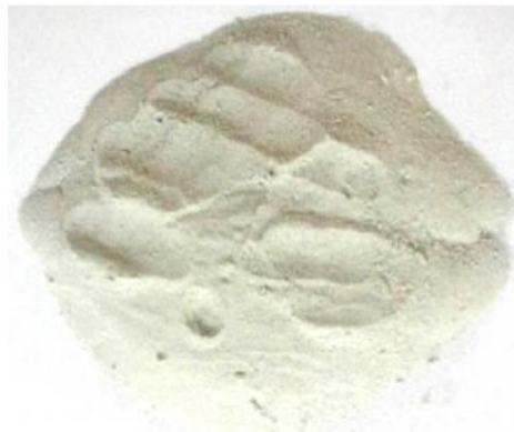
Gambar 2. Senyawa hidroksiapatit dari sintesis tulang sapi Sumber : Fadhliah, dkk. (2016)
