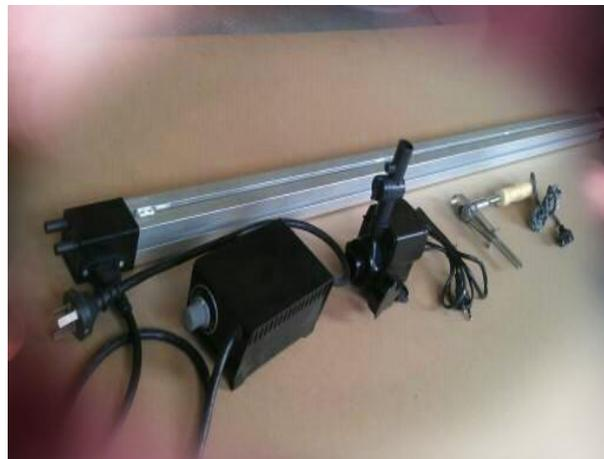
Gambar 2.6 *Acrylic bending machine* yang memiliki pemanas ditengah
