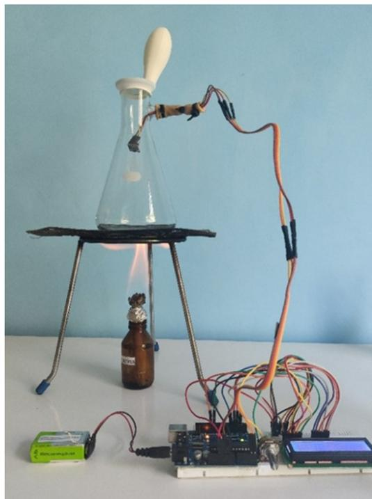
**Figura 2:** Montagem do experimento para dilatação do ar com Arduino e sensor /BMP280.
