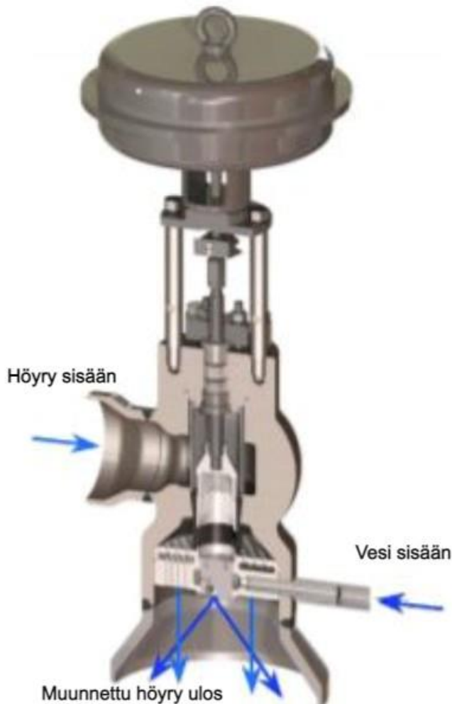
Kuva 5. Reduktioventtiilin rakenne [22]
