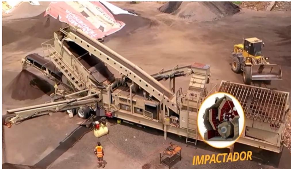
Figura N°21. *Impactador del material reciclado para reducir el tamaño*
