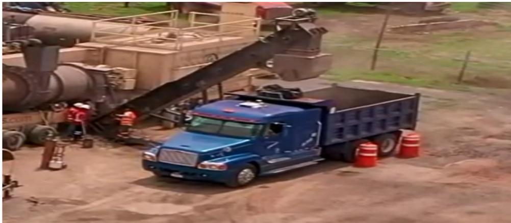
Figura N°26. *Depósito de la mezcla en volquetes*
