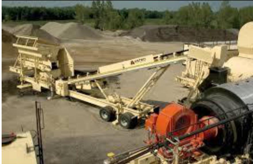
Figura N°31. *Componente mecánico de recepción de material para el procesamiento del material reciclado de pavimento envejecido en la planta de asfalto.*
