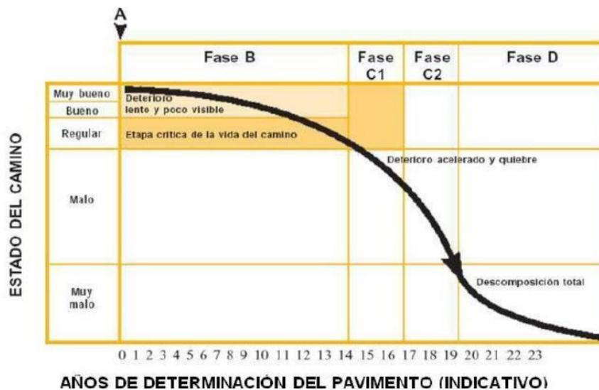
Figura N°3. Fases de un pavimento sin mantenimiento o rehabilitación
