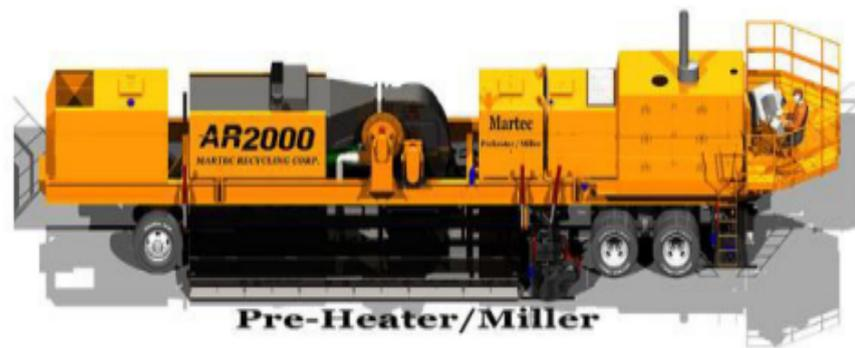
Figura N°15. *Fresadora o Miller*
