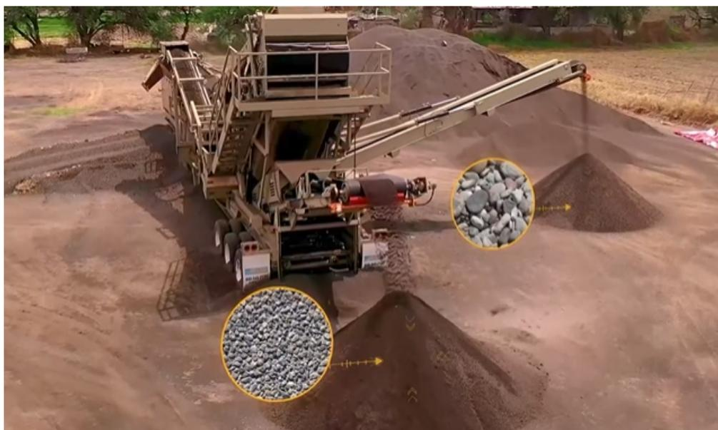
Figura N°22. *Separación de agregados*
