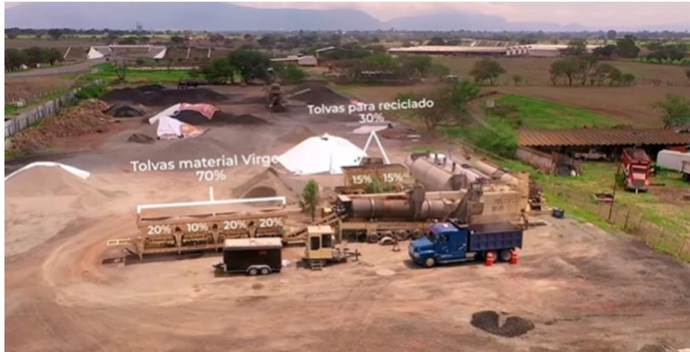
Figura N°27. *Reciclaje de pavimento asfáltico en planta*
