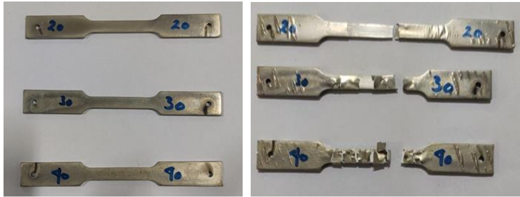
(a) (b) Gambar 4. Hasil patahan dari spesimen (a) sebelum pengujian (b) setelah pengujian
