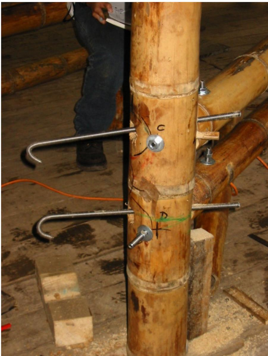
*Esempio di collegamento tra culmi in bambù mediante l'uso di barre filettate*
