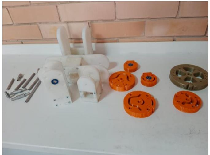
Figura 6. Piezas del brazo robótico, Fuente: Autor
