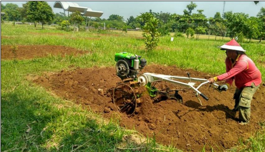
Gambar 4. Pengolahan tanah dengan traktor tangan pada lahan untuk budidaya sorgum
