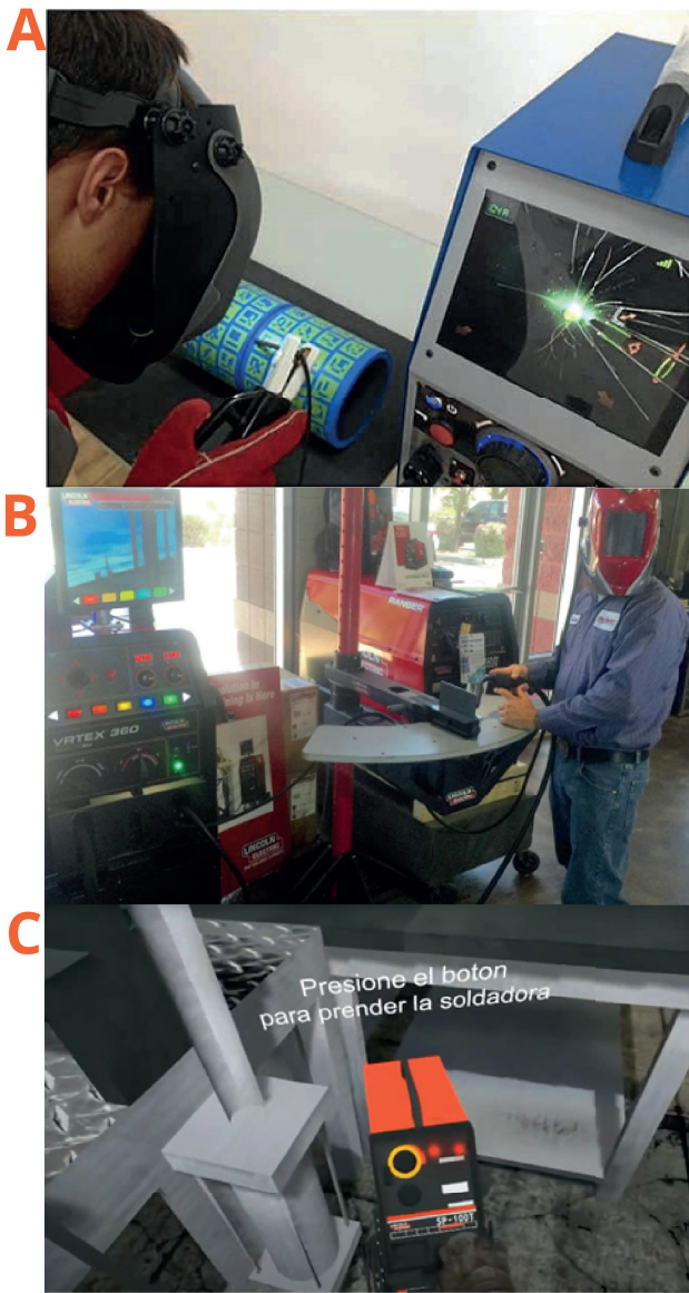
Fig. 5. A) Practica de soldadura mediante realidad aumentada. B) Equipo de realidad virtual en la formación de profesionales. C) Entorno realidad aumentada en la formación como soldador [17].
