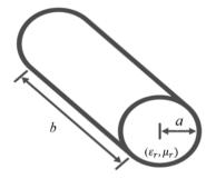
Fig. 1 - Circular terahertz waveguide
