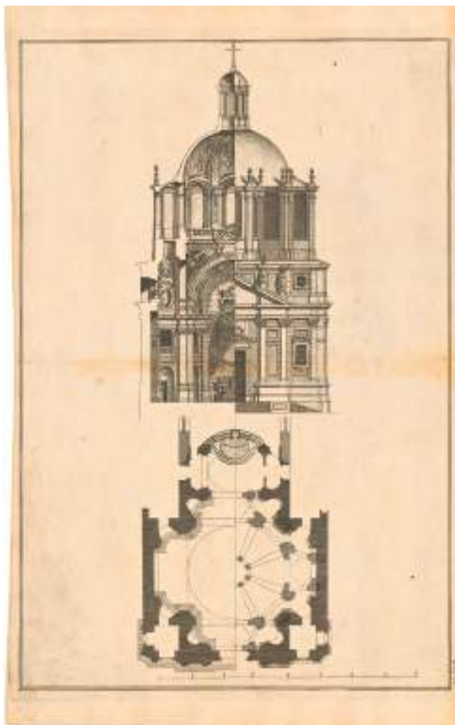
fig.1 – Progetto per la chiesa della confraternita di San Bernardino a Chieri: pianta, metà sezione e metà prospetto (BERNARDO VITTORE, Istruzioni diverse concernenti l'ufficio dell'Architetto Civile [...], 1766, tavola LXVI).
