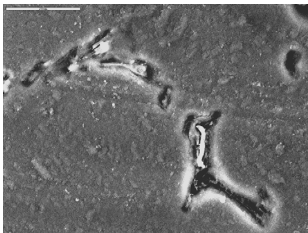
Sl. 3. Poroznost uzorka sa najkraćim vremenom degasifikacije
