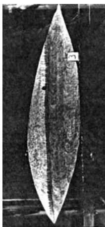
Figure 11. Boat form sample with crack Slika 11. Uzorak oblika čamca sa prslinom
