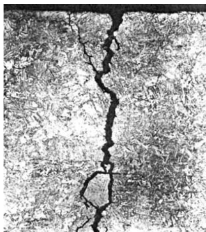
Figure 12. Crack initiation location in the underbead zone. Slika 12. Mesto inicijacije prsline u oblasti ispod zrna
