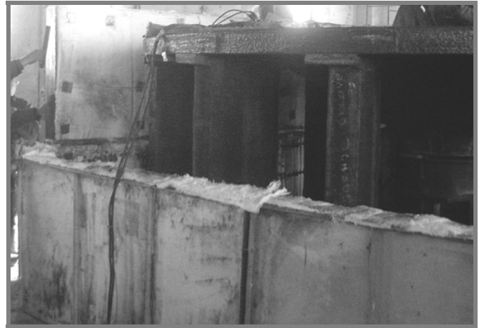
Slika 10: Izgled peći za naponsko žarenje nakon reparaturnog navarivanja
