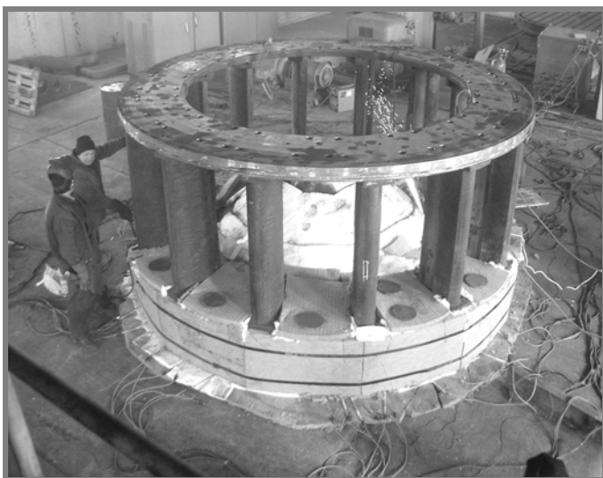
Slika 8: Izgled peći u fazi predgrevanje - navarivanje
