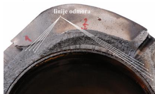
Slika 11 - Linije odmora u sektoru C prelomne površine
