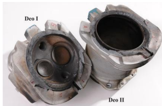
Slika 6 - Cilindar motora Lycoming IO-360-B1F nakon „otvaranja“ prsline
