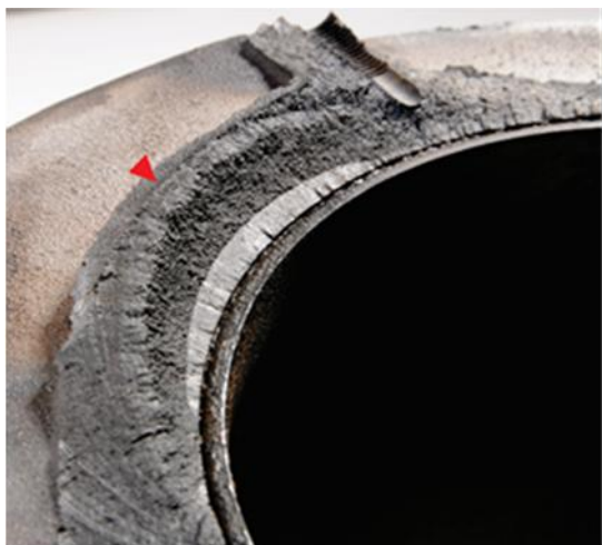
Slika 10 - Sektor B površine loma sa mestom na kome je prslina dostigla debljinu zida
