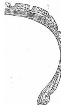
Slika 9. Razlaganje konstrukcije radi primene MKE analize
