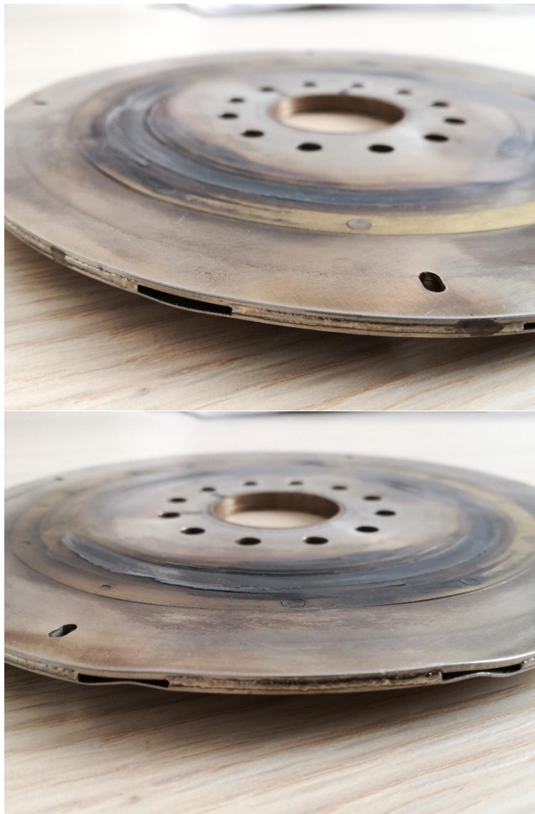
Слика 6.9. Трајно (пластично) деформисани облик преграде конструкционе варијанте 2
