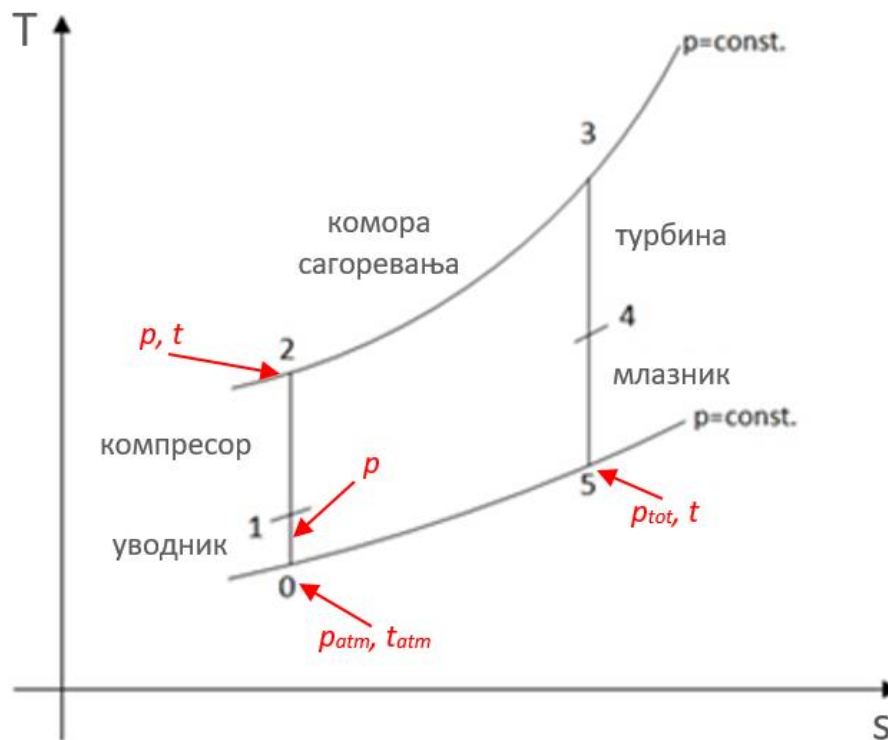
Слика 4.11. Идеални Брајтонов циклус приказан кроз фазе и мерне тачке током испитивања мотора
