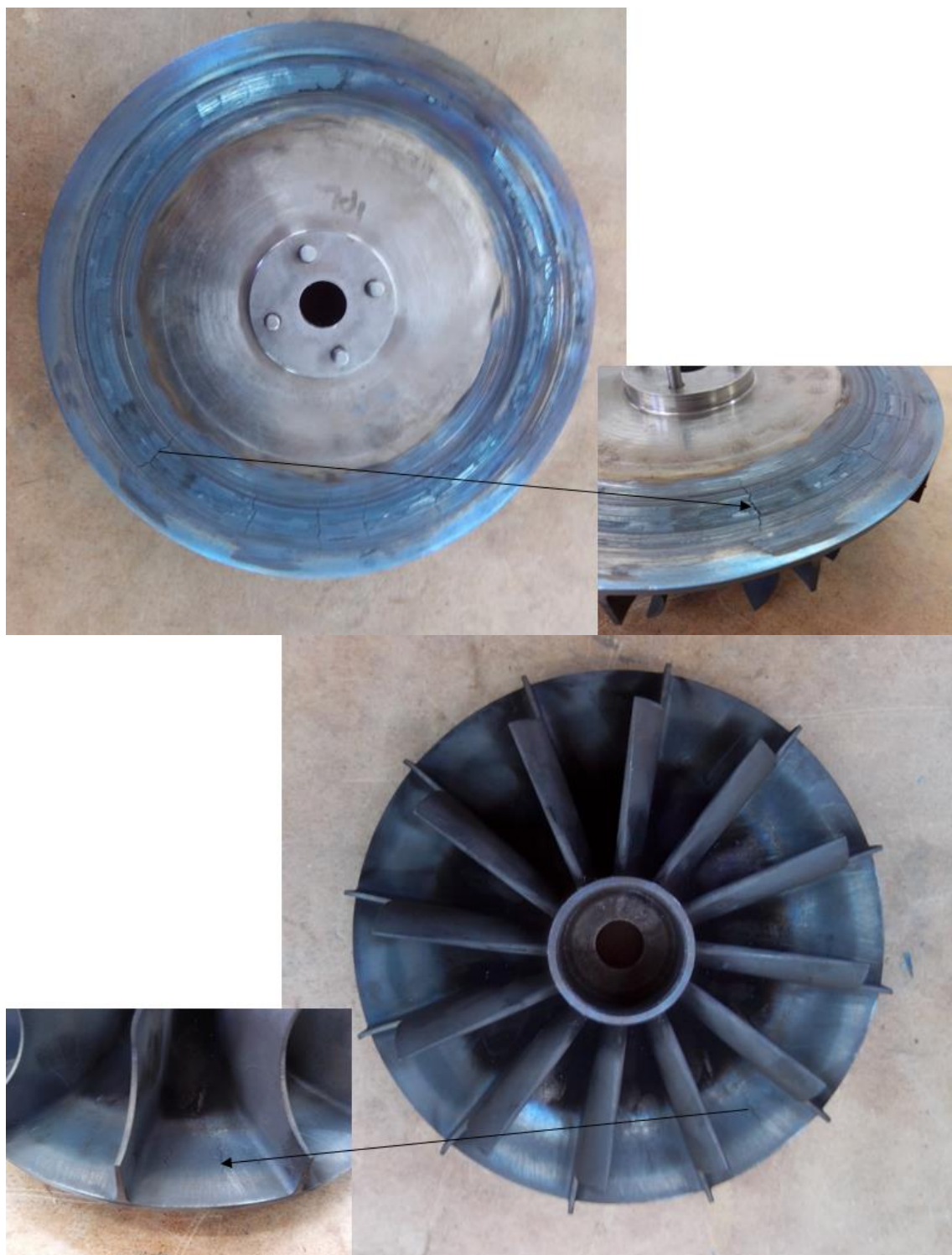
Слика 6.11. Оштећења на турбини при испитивању са преградом - варијанта 2: диск турбине (горе) и међулопатични простор (доле)
