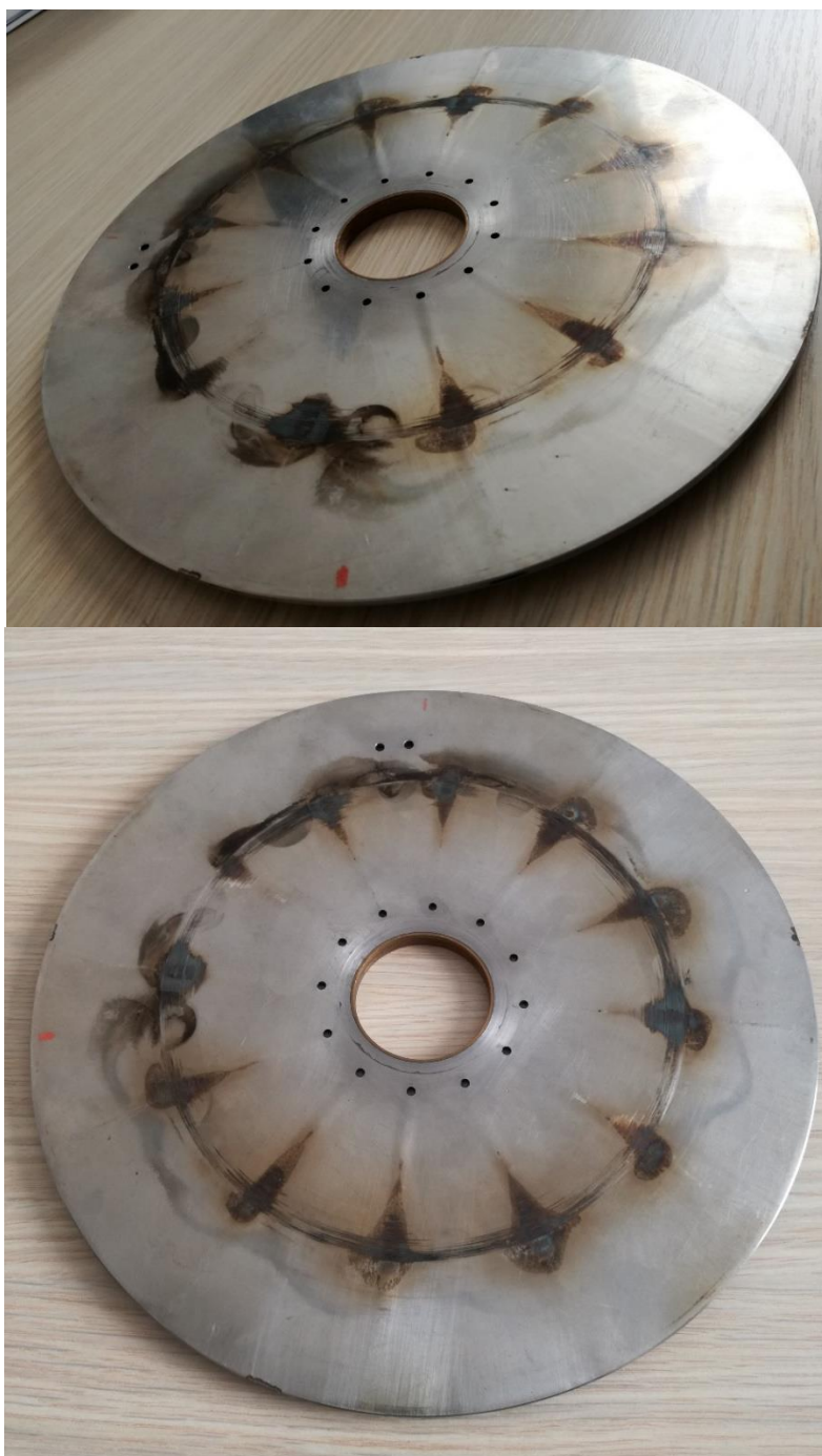
Слика 6.3. Деформације и оштећења преграде у додиру са диском турбине
