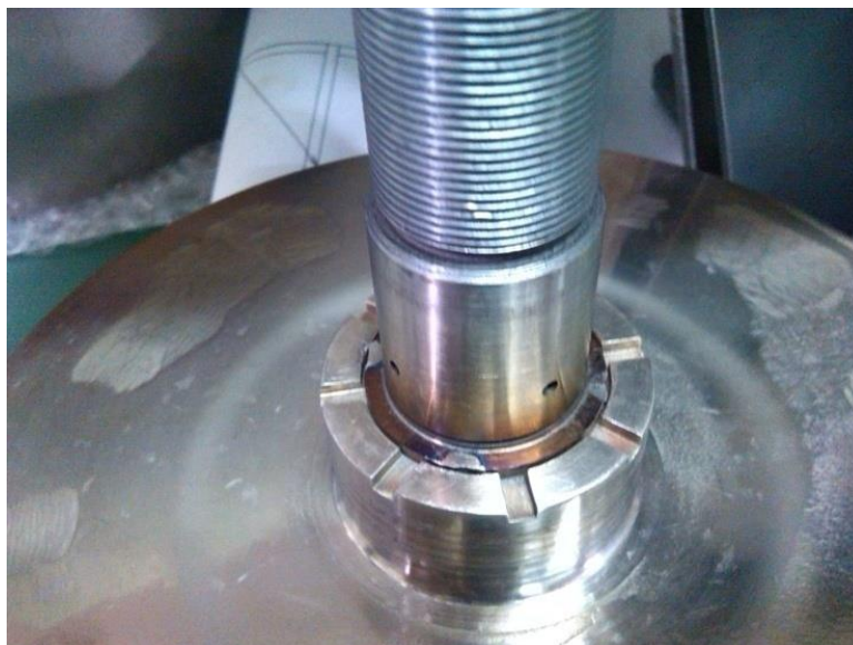
Слика 6.26. Диск турбине на коме је ваздух за хлађење оставио траг у току рада гасогенератора
