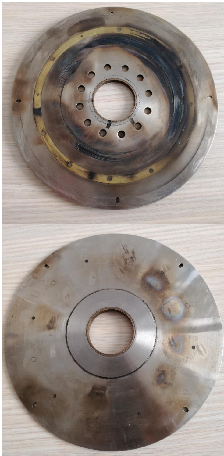
Слика 6.10. Оштећења на прегради - варијанти 2: страна према турбини (горе) и страна према компресору (доле)
