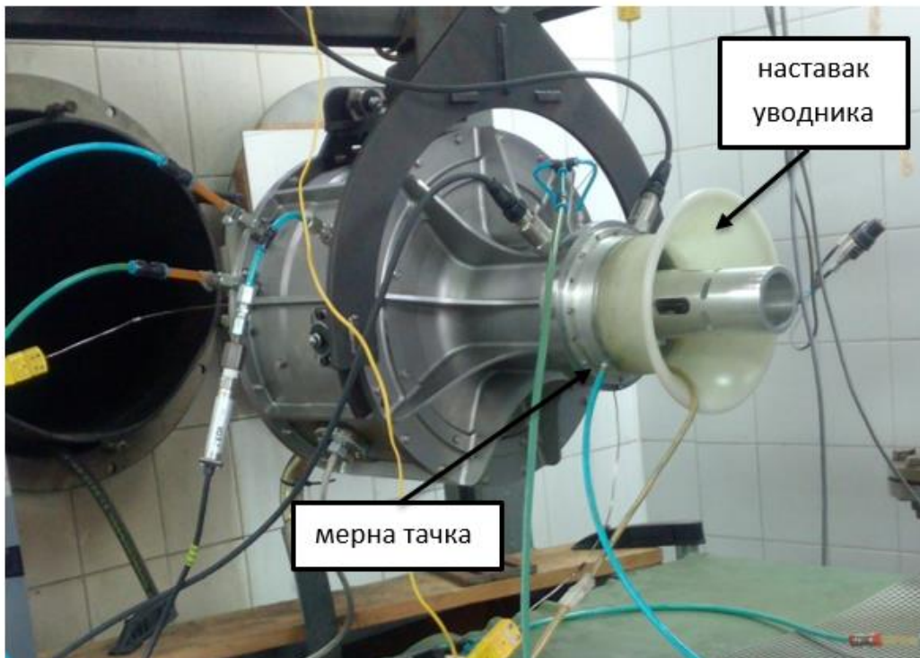
Слика 4.18. Мерење подпритиска у уводнику
