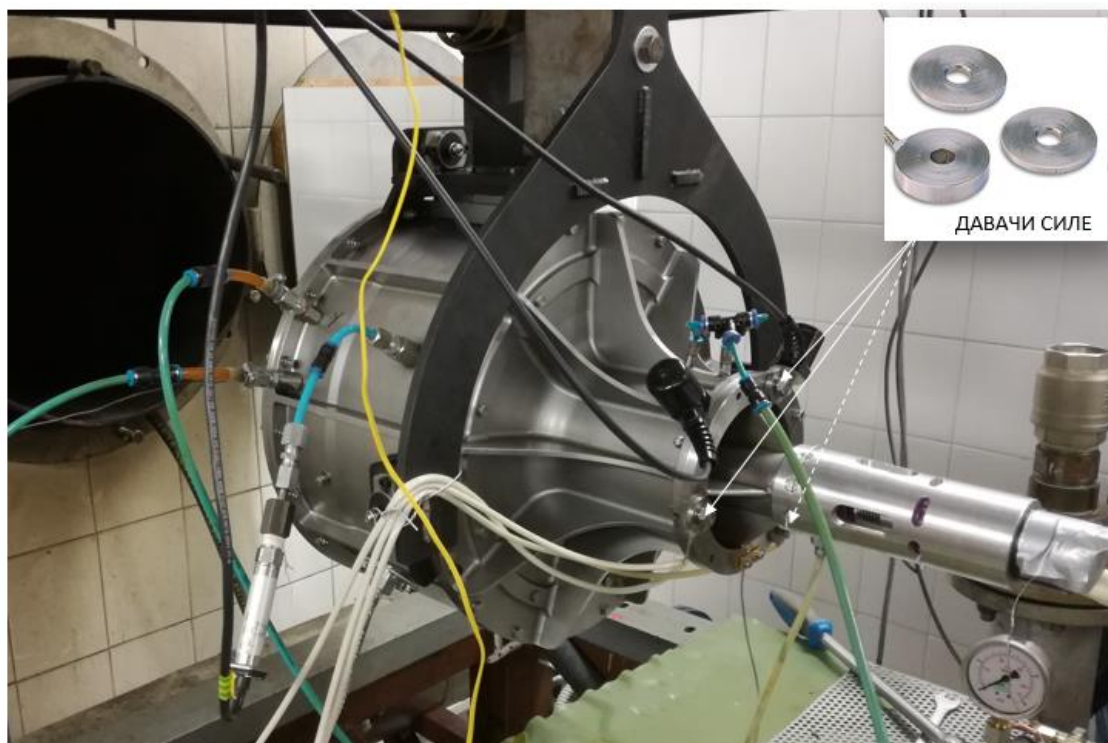
Слика 4.21. Мерење аксијалне силе на носачу лежаја ротора гасогенератора
