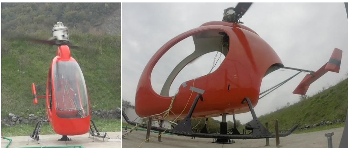
Слика 4.4. Лебдење, одизање од тла за 10 ст, хеликоптера на полигону за испитивање
