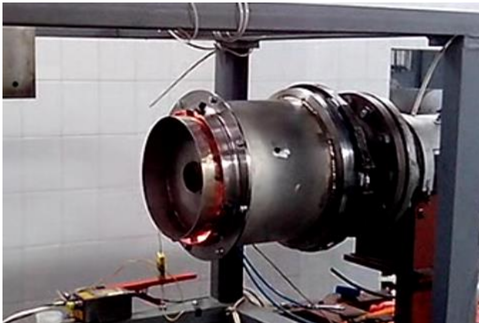
Слика 4.10 Испитивање коморе сагоревања на посебној инсталацији
