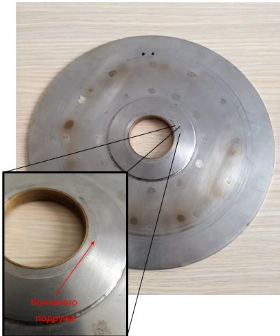
Слика 6.5. Оштећење благог карактера на прегради услед контакта са компресором
