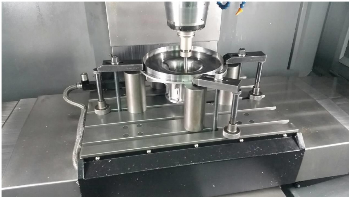
Слика 4.6 Мерење и провера толеранција облика профилне контуре кућишта мотора
