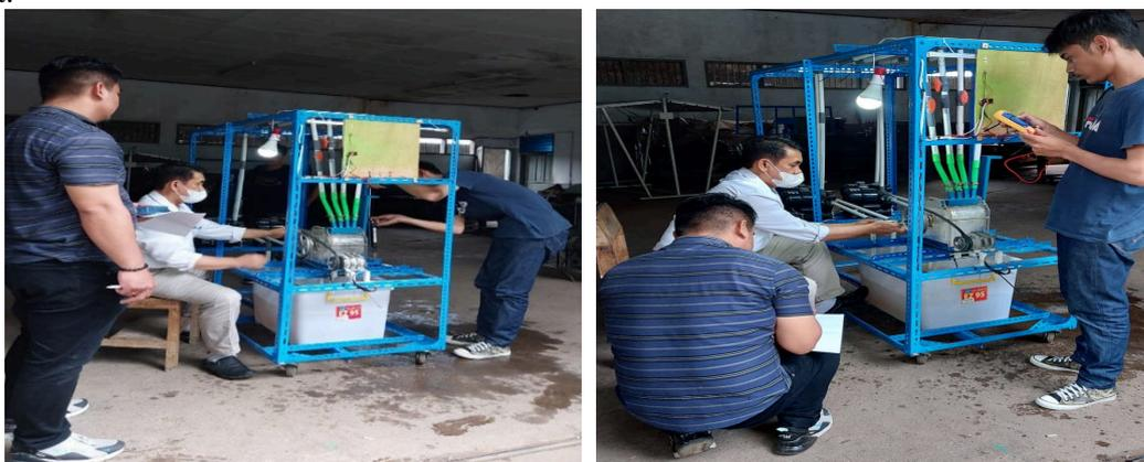
Gambar 1. Rangkaian pengujian dari turbin *cross-flow* 4 (empat) nosel
