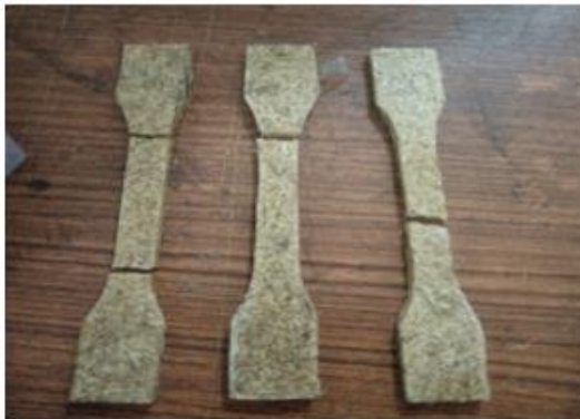
Gambar 2. Hasil uji tarik 70% resin, 30% komposit
