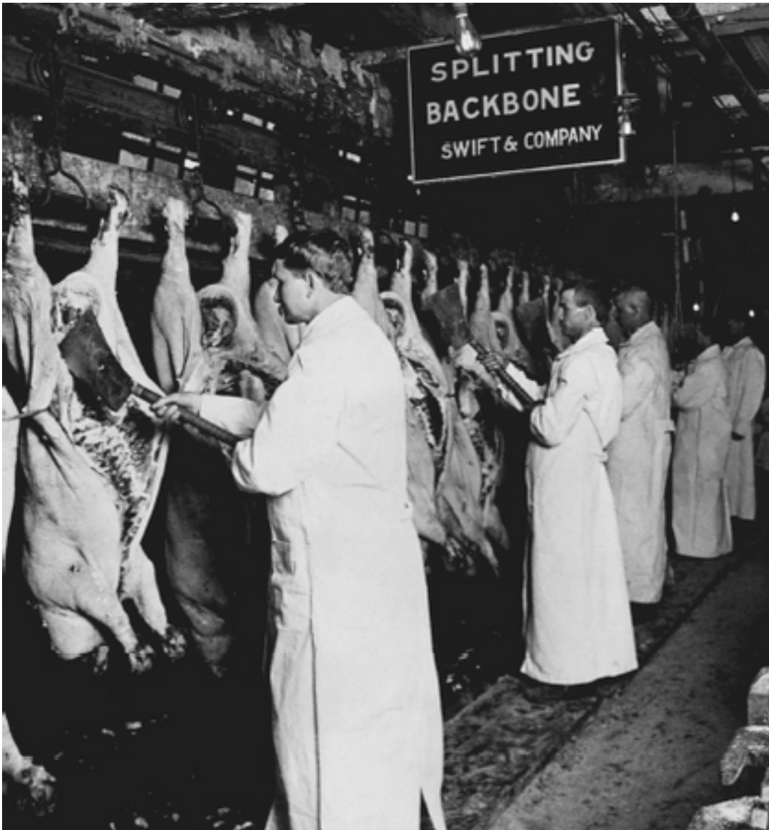
Fig. 2 – Swift & Company's Meat Packing House, Chicago, Illinois, 1910-1915. Processo di Splitting Backbones and Final Inspection of Hogs dopo l'applicazione del "Meat Inspection Act" emanato dal Congresso US nel 1906. Tratta da: http://collections.thehenryford.org/ .
