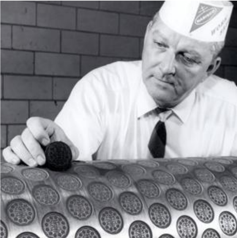
Fig. 11 – Operaio della Nabisco (National Biscuit Company) che mostra il rullo a stampo per la produzione dei biscotti Oreo, anni '70.
