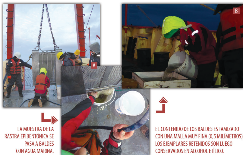
Figura 3. Cuando la rastra epibentónica (A) llega a la cubierta, se recoge su contenido en baldes e inmediatamente después se recuperan los ejemplares tamizando la muestra (B). Su contenido se almacena en frascos más chicos que llegan al laboratorio.
