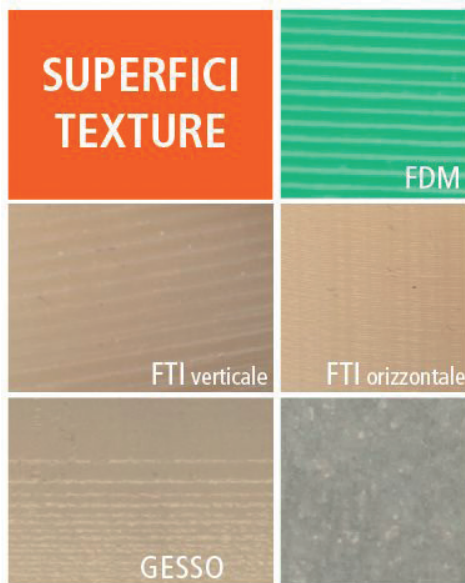
Figura 9 - Macro ingrandimento delle superfici dei prototipi al variare delle tecnologie additive
