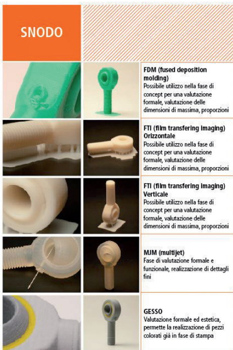
Figura 4 - Campioni dello snodo con una breve descrizione delle tecnologie utilizzate per la loro realizzazione, "campi applicativi" dei diversi prototipi
