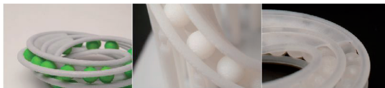
Figura 16 - A sinistra il campione del ciondolo in gesso, nel centro un dettaglio dei supporti del campione FTI e a destra il prototipo in MJM
