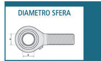
Figura 13 - Quote interne del diametro della sfera, rilevate perpendicolarmente tra loro
