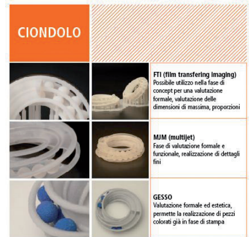
Figura 5 - Campioni del ciondolo con una breve descrizione delle tecnologie utilizzate per la loro realizzazione, "campi applicativi" dei diversi prototipi
