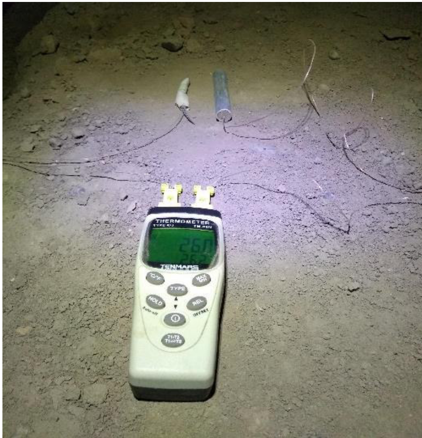
Figura 3. Calibración del modelo de PVC para el registro de temperaturas operativas en campo.
