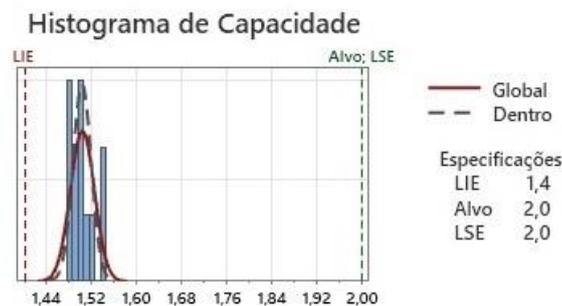
Figura 35: Histograma da capacidade para a espessura
