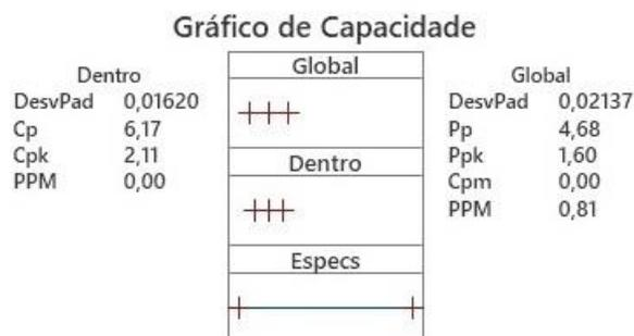
**Figura 39:** Gráfico de capacidade para a espessura
