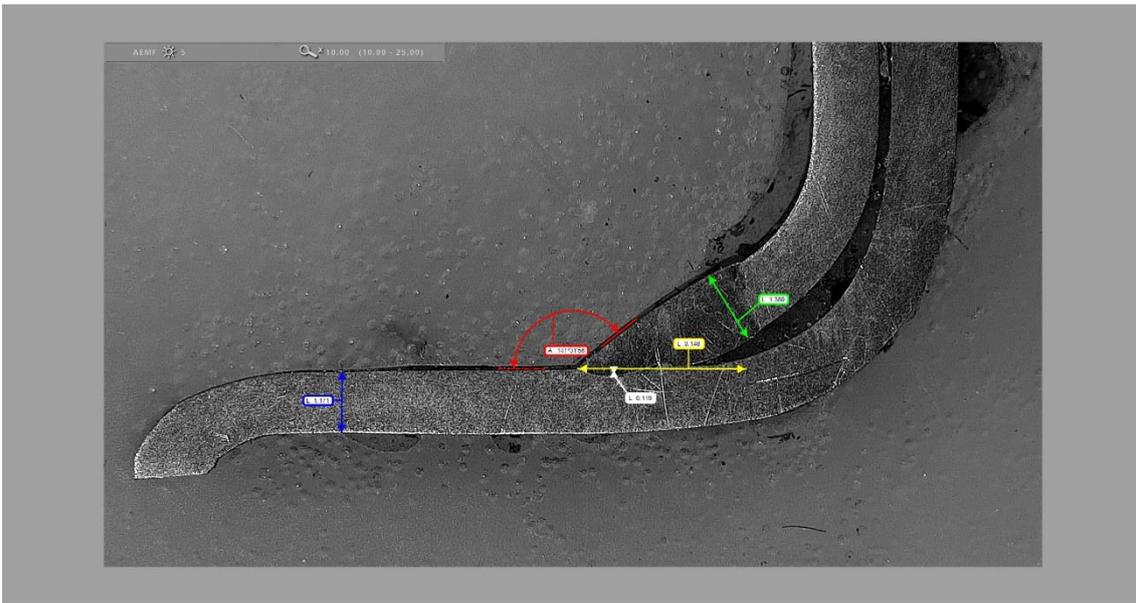
*Ensaio 1 – medições segundo Requirements for ARC Welding Joints\_Ref. FSE-S-PSE\_G057/EN*
