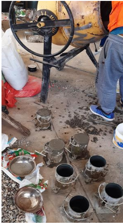
Anexo 9 Muestras de concreto Fresco en los Moldes
