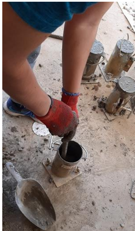
Anexo 8 Chuseo del concreto en los Moldes de 4"x8"
