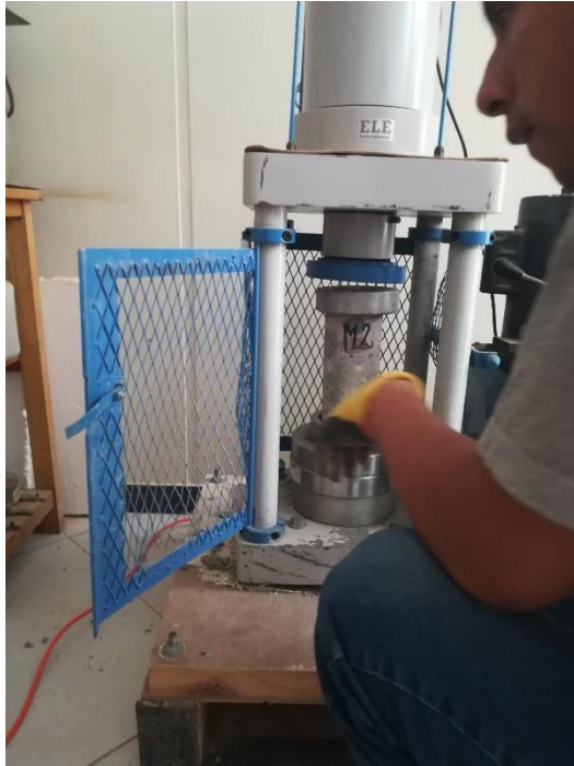
Anexo 11 Colocación de Probetas en la Prensa de compresión
