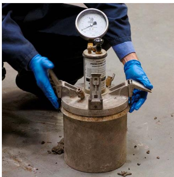
Ilustración 10 Método de Ensayo Normalizado de Contenido de Aire del Concreto Recién Mezclado Mediante el Método por Presión Fuente: Laboratorio IMCYC – México D.F.
