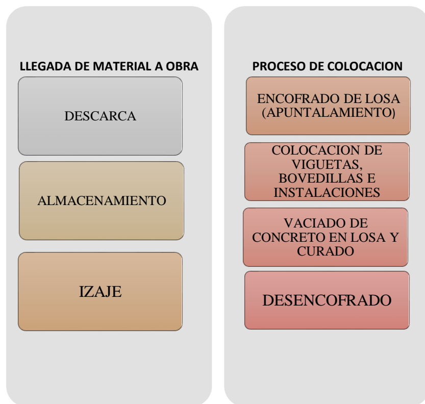
Proceso constructivo sistema de viguetas pretensadas Fuente: (propia 2021)
