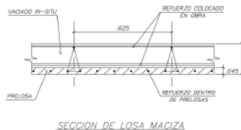
Figura 2: Detalle de losa maciza con prelasas.
