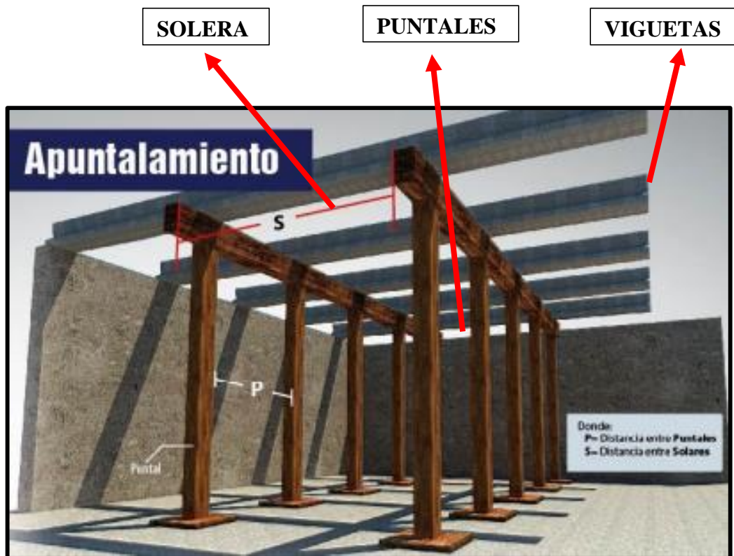
Modo de apuntalamiento Fuente: (SUPERMIX)
