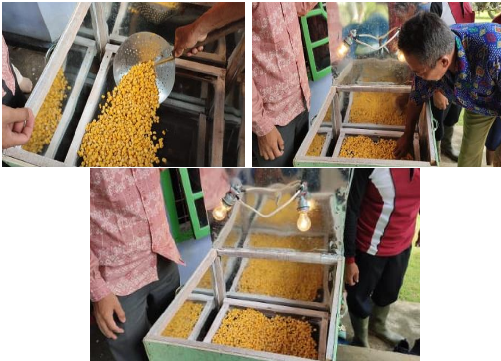
Gambar 5. Proses fruit dryer technology digunakan untuk pengeringan jagung maring
