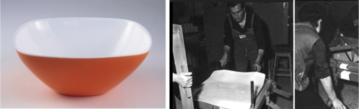
A sinistra, contenitore per usi domestici realizzato mediante termoformatura di lastra bicolore opalina in PMMA, progetto interno di Giovanni e Raimondo Guzzini, 1952. Proprietà Fratelli Guzzini. A destra, fasi della termoformatura della lastra bicolore. (Fonte delle immagini: ww.archivio.fimag.it ).
