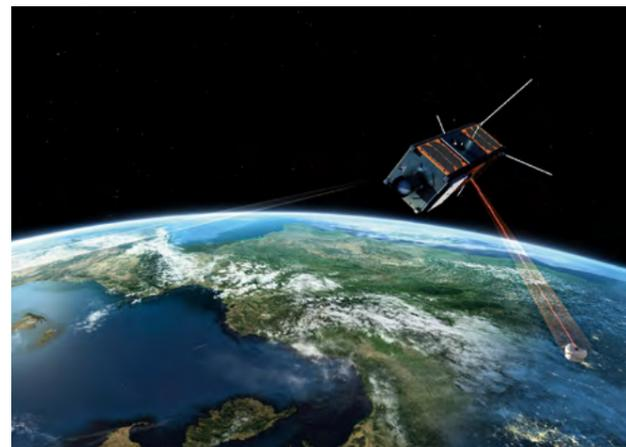
Der Kleinsatellit PIXL-1 trägt das Laserterminal OSIRIS4CubeSat. Dessen System besteht aus einer hochkompakten Kombination aus Elektronik und Optomechanik.
