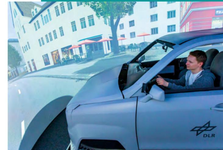
Im Virtual-Reality-Labor des DLR wird am automatisierten und vernetzten Fahren geforscht. Für möglichst detailgetreue Tests hat ein Mittelklassewagen Platz im Labor und die 360-Grad-Darstellung ermöglicht einen Rundumblick.
