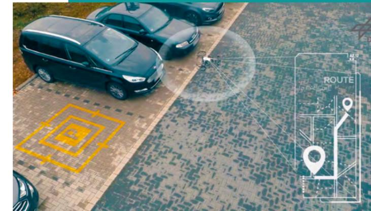
Im Projekt AUTOPILOT hat das DLR autonomes Einparken erprobt. Das Auto wird mittels einer App auf Parkplatzsuche geschickt – wenn das System mithilfe einer Drohne eine geeignete Stelle ausgemacht hat, navigiert es das Fahrzeug dorthin und parkt es ein.
