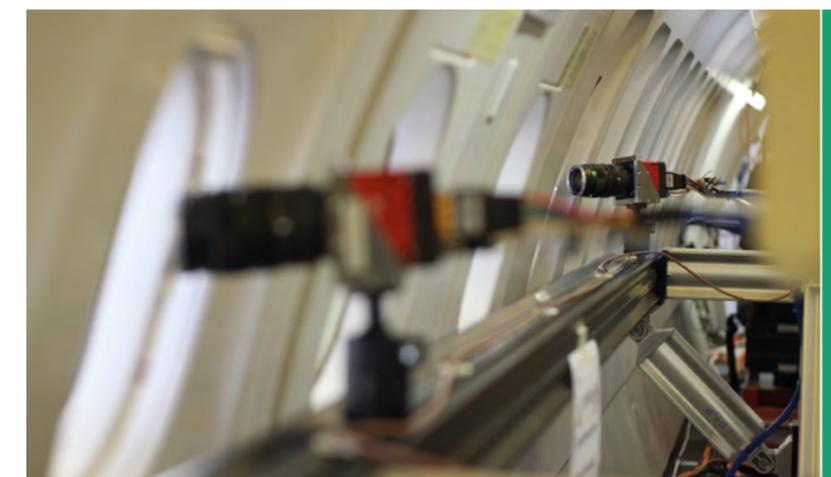
Mit einem in der Flugzeugkabine installierten Stereokamerasystem wurde die Deformation der Tragfläche während verschiedener Flugmanöver vermessen.
