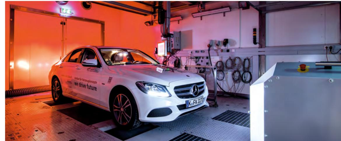
Auf dem klimatisierten Allrad-Rollenprüfstand testen die DLR-Ingenieurinnen und -Ingenieure Autos mit Verbrennungsmotor, Elektro- und sogar mit Wasserstoffantrieb in genormten Fahrzyklen auf „Herz und Nieren“ – mit bis zu 200 Stundenkilometern.
