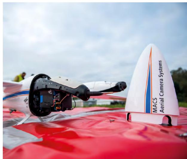
Die Drohne mit integriertem Luftbildkamerasystem MACS (Modular Aerial Camera System) dient zur optischen Aufklärung von Großschadenslagen.
