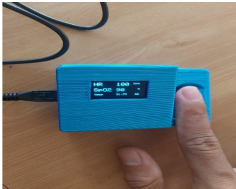
Gambar 12. Tampilan Heart Rate , SpO2 dan Temperature : Diatas Normal pada LCD
