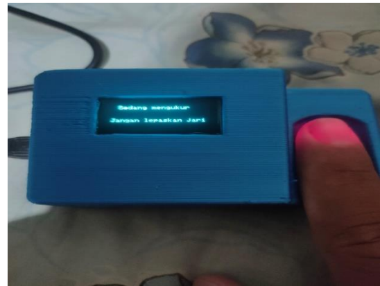
Gambar 9. Tampilan Heart Rate , SpO2 dan Temperature : Perintah Sedang Mengukur Jangan Lepaskan Jari Pada LCD
