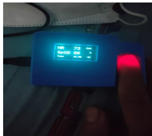
Gambar 10. Tampilan Heart Rate , SpO2 dan Temperature : Normal pada LCD
