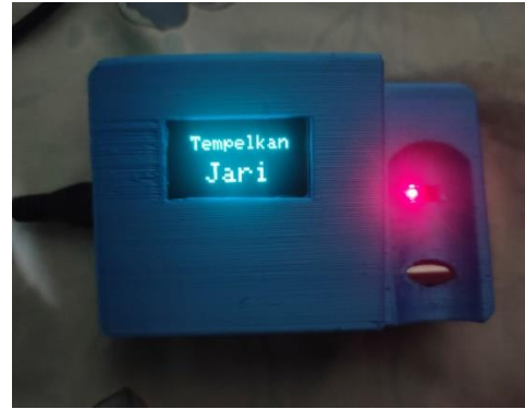
Gambar 8. Tampilan Heart Rate , SpO2 dan Temperature : Perintah Tempelkan Jari Pada LCD
