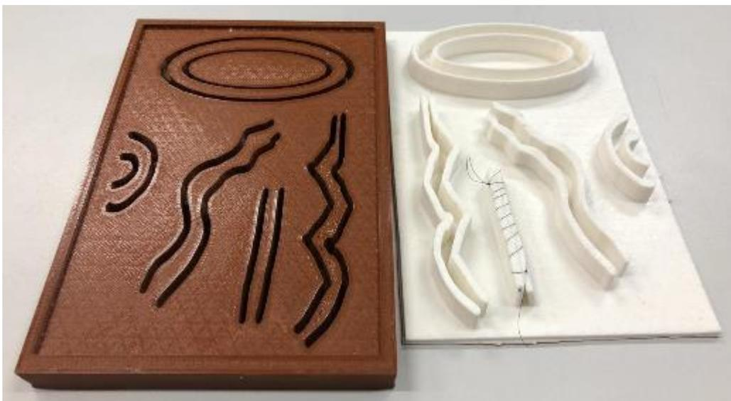
**Figura 3:** Protótipos de sutura moldados na impressora 3D e preenchidos com silicone para treinamento de suturas manuais e laparoscópicas.
