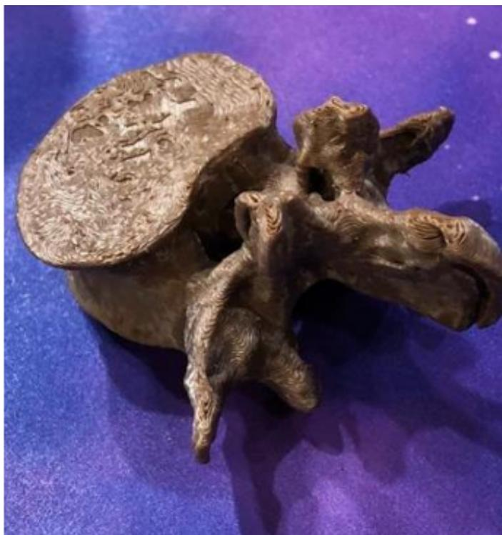
Figura 1: Segmento de vértebra anatômica impresso em 3D.
