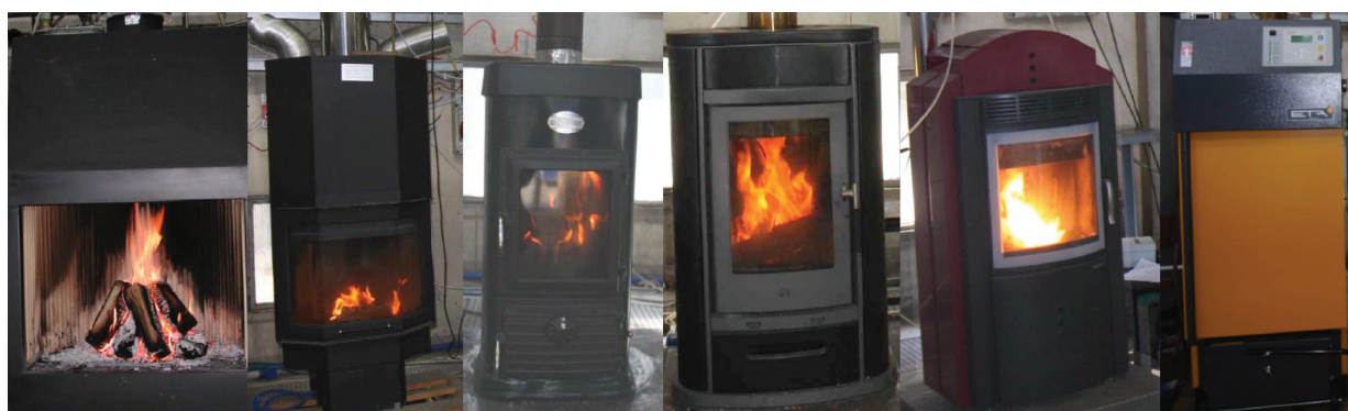
Figura 1 – Apparecchi utilizzati nella sperimentazione (da sinistra: caminetto aperto, caminetto chiuso, stufa tradizionale, stufa avanzata, stufa a pellet, caldaia a pellet)
